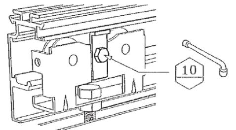
Mise en place du système anti-déraillement.
