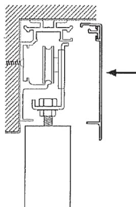
Mise en place du bandeau d'habillage. Caler le bandeau sur le rail avec le clips en bout de rail.
