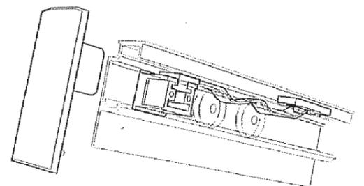
Mise en place du capot d'extrémité de rail.
