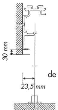
Fixation en bout de rail avec équerre de suspension.
