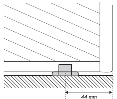
Positionner l'axe du guide bas 44 mm en retrait par rapport au bord du vantail et dans l'axe du chemin de roulement haut.
