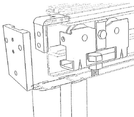
Si vous souhaitez une reprise d'effort contre un mur (permet de soulager la fixation plafond), utilisez les équerres de suspension en bout de rail.
