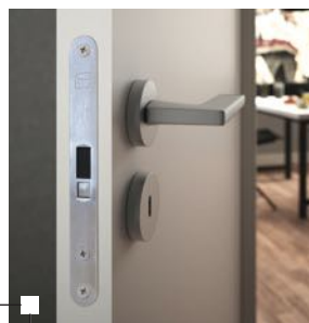
Accessoire disponible : adaptateur à condamnation carré 6 mm pour serrure à encastrer. Il permet de transformer une serrure à cylindre européen en une serrure bec-de-cane à condamnation.
